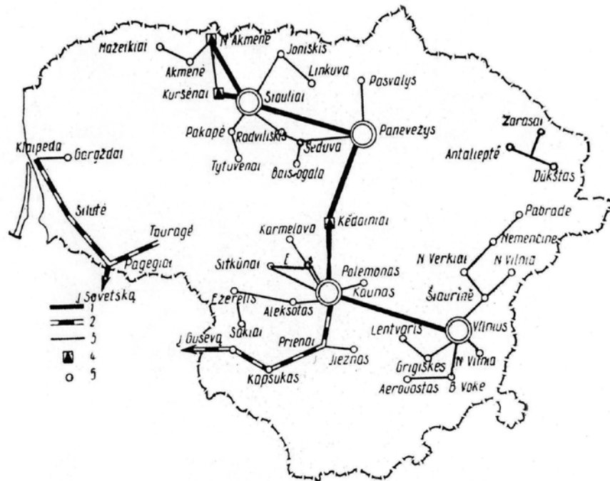
Lietuvos energetikos sistemos 110–35 kV tinklų 1959 metų schema.
