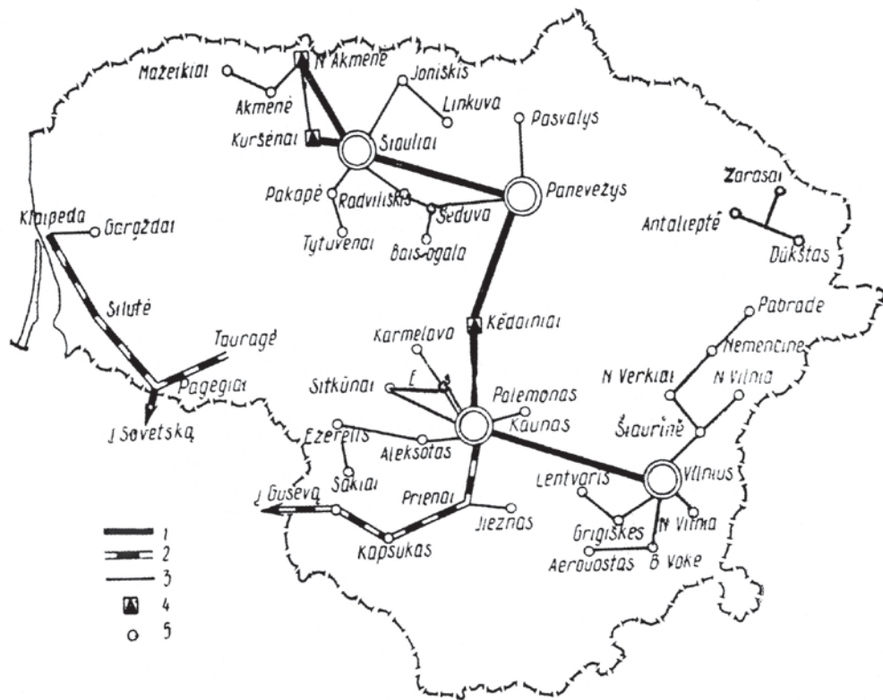
1959 m. Lietuvos energetikos sistemos 110–35 kV įtampos elektros tinklų schema.
